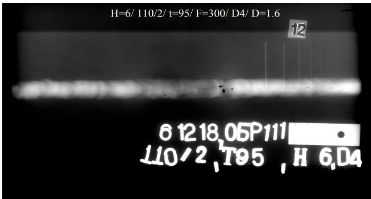
Рисунок 2 – Рентгеновское изображение стальной пластины, полученное с помощью рентгеновской плёнки
