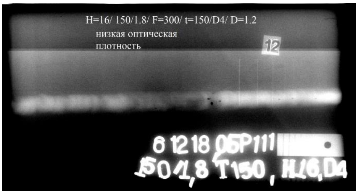
Рисунок 6 – Рентгеновское изображение стальной пластины, полученное с помощью рентгеновской плёнки
